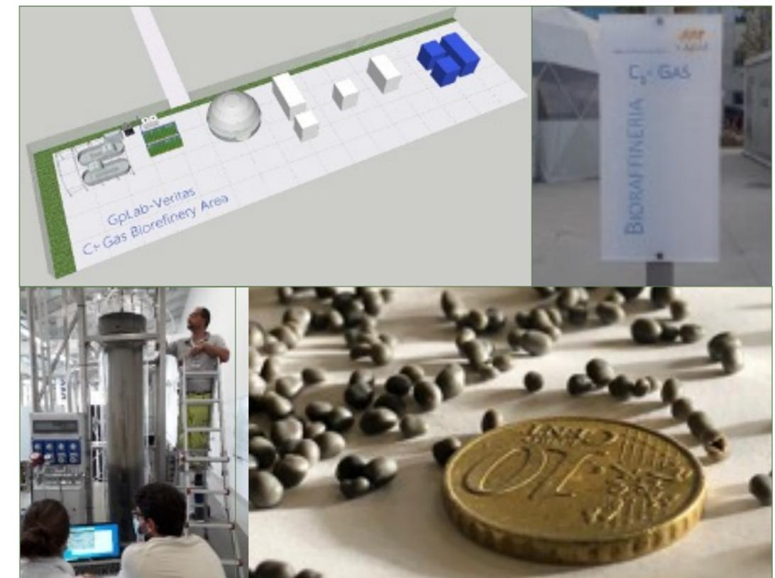
Biometanatore Phoenix con batteri metanigeni granulari
