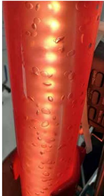
Figura 3: particolare dei batteri immobilizzati in fase di produzione idrogeno (bolle)
