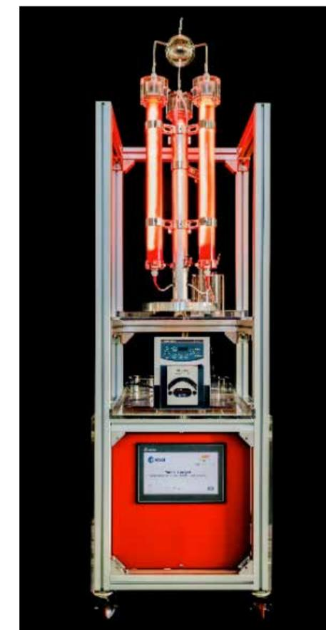
Figura 1: prototipo fotobioreattore Purple-B» per la produzione di bioidrogeno
