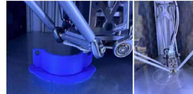
Figura n.5: realizzazione, con stampante 3D a filo, di componenti del reattore Purple-B
